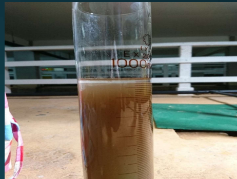
Tangki Aerasi SV
