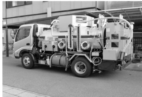
写真 7-4 浄化槽汚泥濃縮車の例
