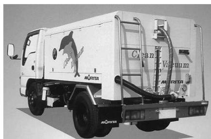
写真7-3 パネル架装バキューム車<sup>2)</sup>
